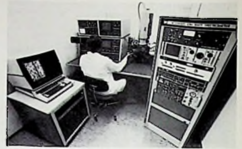
Bild 6. Qualitätssicherung durch Forschung mit Röntgenraster-Mikroskop und Sekundärionen-Massenspektrometer. Sie erlauben die Untersuchung physikalischer und chemischer Zusammenhänge in extrem dünnen Schichten
